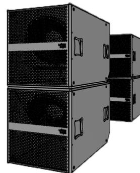
La disposizione End Fire avviene tramite 2 o più elementi separati da una distanza pari ad 1/4 della lunghezza d'onda per la quale si vuole la massima cancellazione, e con il primo Subwoofer, quello più vicino al pubblico, ritardato elettronicamente del valore necessario per portarlo virtualmente alla stessa posizione di quello più vicino al palco.
