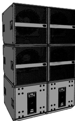
La disposizione Cardioide stacked, prevede 2 o più subwoofer disposti uno sopra l'altro ed uno viene rivolto verso il palco, ritardato elettronicamente di un valore opportuno che può variare a seconda dell'installazione tra 3,5 e 5ms e poi invertito di fase, questa configurazione riduce la radiazione posteriore del subwoofer.
