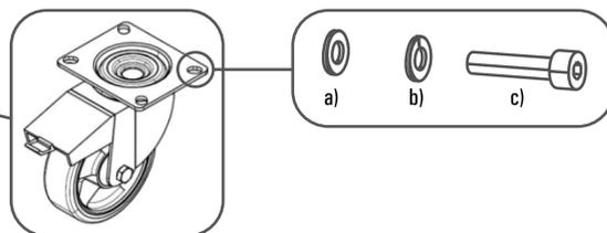
Tramite tali punti è possibile svitare la vite a testa piatta per installare il golfare M10 o apposite staffe a L, tale operazione è consigliata per il fissaggio a terra in installazioni fisse o a lungo termine evitando il camminamento dello stesso, non usare mai questi punti per una sospensione aerea, questo apparecchio non può essere appeso.
